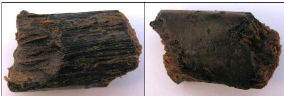
Figuur #. Rondhout dat aan de ene zijde gaaf is, compleet met schors en aan de andere zijde sterk verweerd/verrot.
